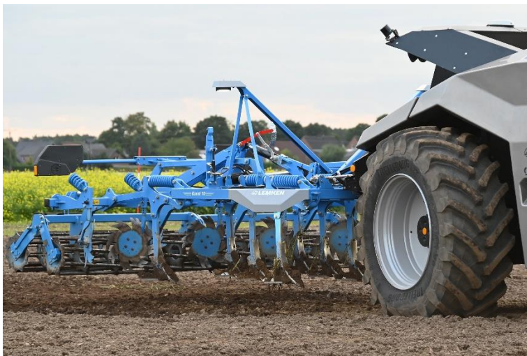
Image 4 : "iQblue tool monitoring" de LEMKEN analyse l'image assistée par IA est utilisée ici pour évaluer automatiquement l'état des socs du cultivateur en tournière.
