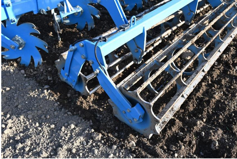
Image 3 : "iQblue slippage control" de LEMKEN mesure en continu le glissement des rouleaux.
